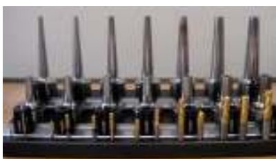
B5_Haimer_Kühlhülsen: Mini Shrinks sind die besonders schlanken Schrumpffutter von Haimer. Für alle Größen stehen passende Kühlhülsen zur Verfügung.
